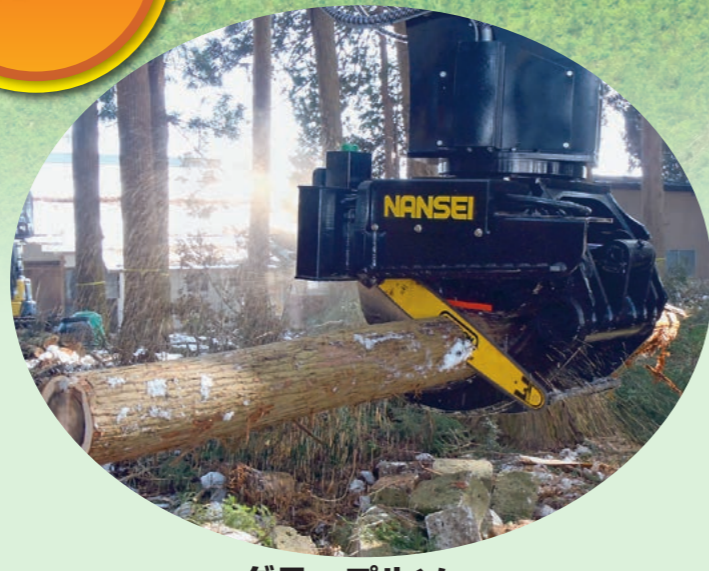
グラップルソー 最大玉切り径 / 600mm
