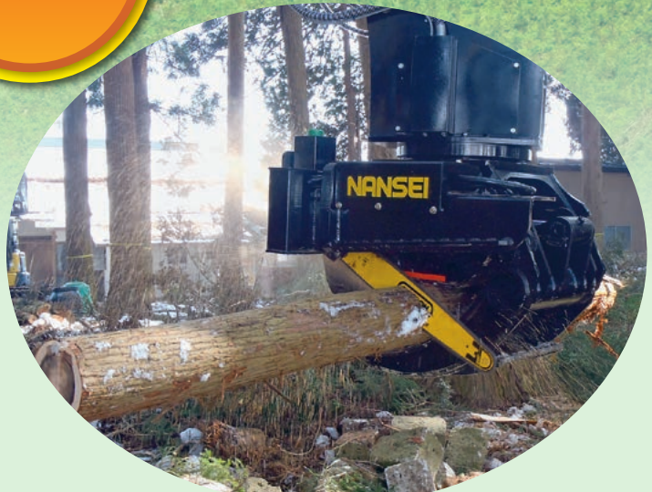
グラップルソー 最大玉切り径／600mm
