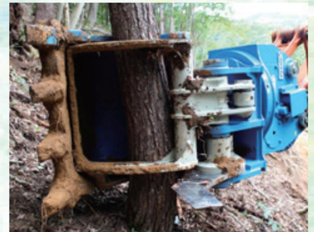
接触面積を最小化するストレート刃により、スムーズな切断が可能に
